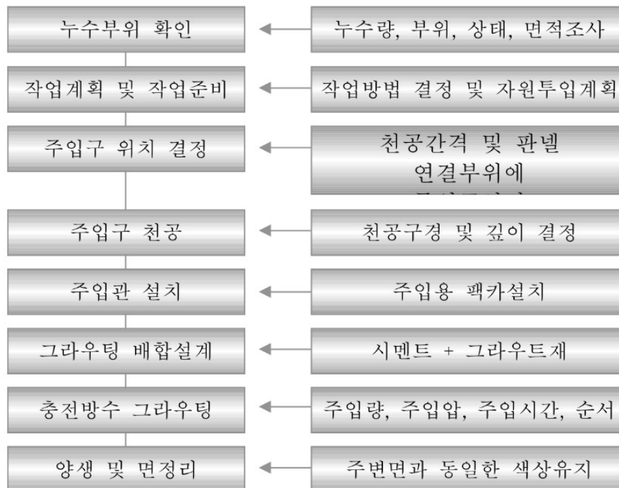
【그림 6.3.10】 충전주입방수 공법의 시공순서도
