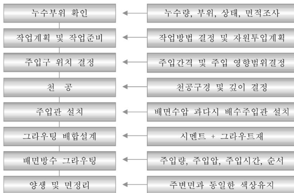
【그림 6.3.12】 배면주입방수 공법의 시공순서도
